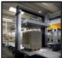
**SISTEMAS AUTOMATICOS DE FLEJADO:** recomendamos una máquina flejadora vertical de prensa ideal para la industria de corrugado. Cuenta con el cabezal de flejado GS41 fabricado y diseñado por MJ Maillis de última generación para flejado de PP o PET.
